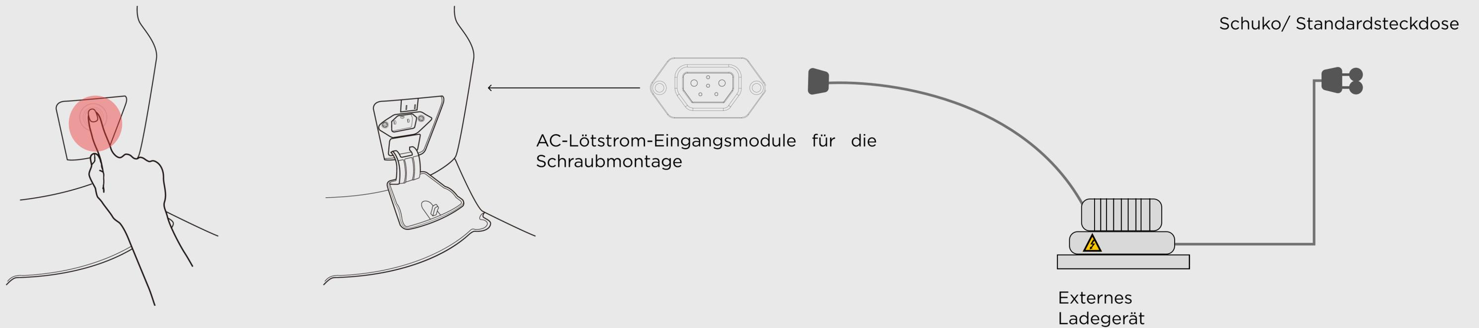
↳ Externes Ladegerät - Drücken Sie vorsichtig auf die Oberseite der Abdeckung, wo sich der Stecker befindet, um Zugang zur Ladebuchse zu erhalten. Nehmen Sie das Ladegerät, schließen Sie es an und achten Sie auf die Kontrollleuchte, die Sie darauf hinweist, dass der Ladevorgang abgeschlossen ist.
